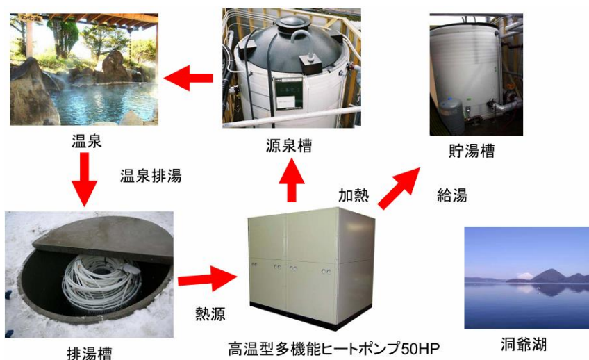
図 4-8 「湖畔の宿 洞爺 かななみ」での温泉排湯の利用
