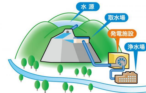
水道施設への水力発電導入例：札幌市
